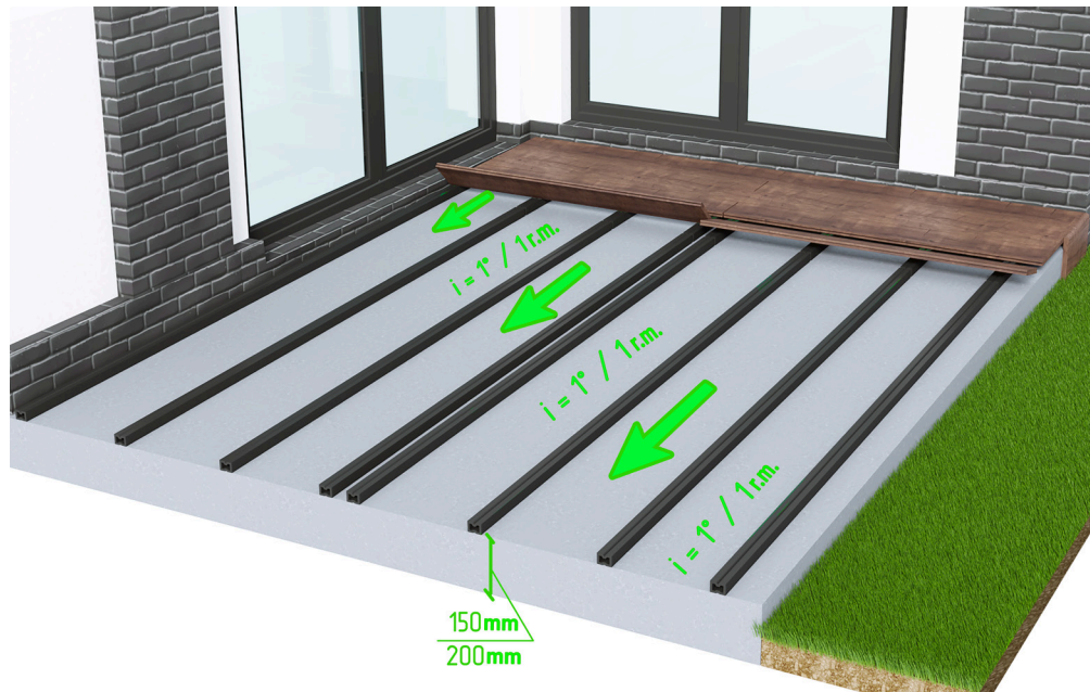
Installation eines Standardbodenbalkens auf einer Betonunterlage mit Gefälle
